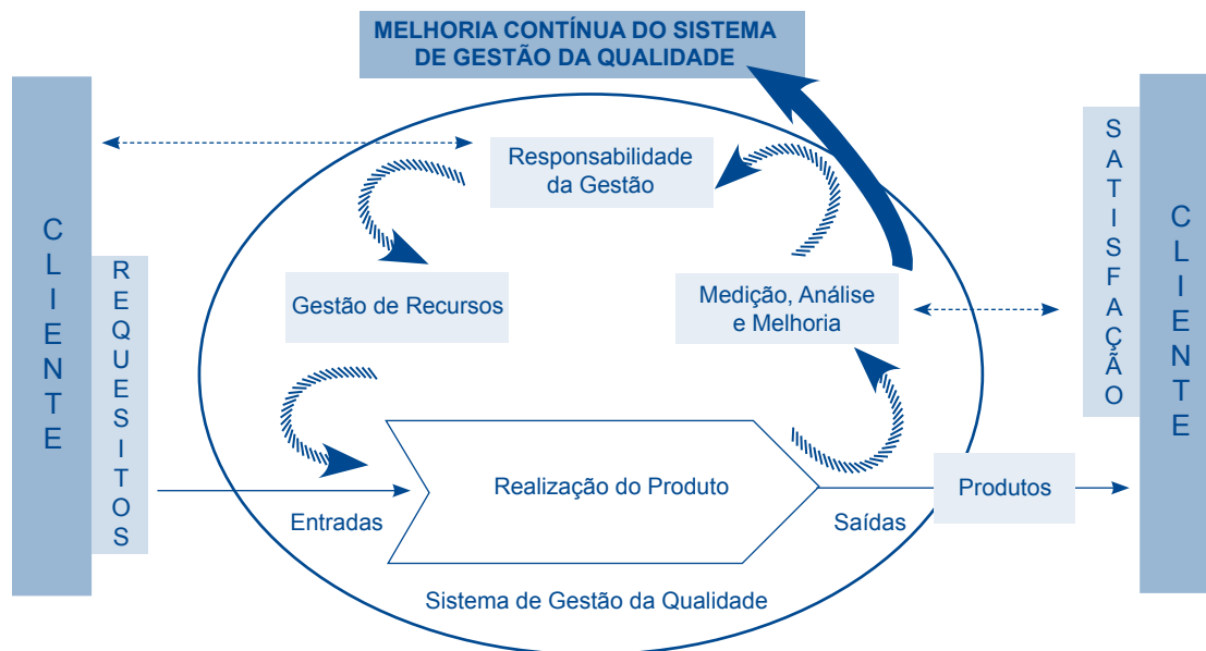
FIGURA 1 – Modelo de um sistema de gestão da qualidade baseado em processos (NP EN ISO 9001:2000)
